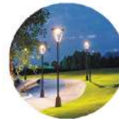
Основное освещение: Высота опоры 2,5-3м Цветовая температура 3000-4000К
