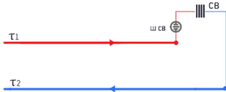
Рис. 2.2.24. Схема №25. Потребитель с вентиляционной нагрузкой
