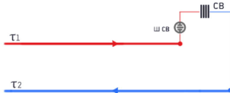
Рис. 2.2.24. Схема №25. Потребитель с вентиляционной нагрузкой
