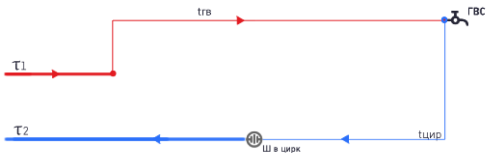
Рис. 2.2.25. Схема №26. Потребитель с открытым водоразбором и циркуляционной линией
